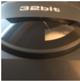
Defektes Amiga CD32 Sichtfenster
