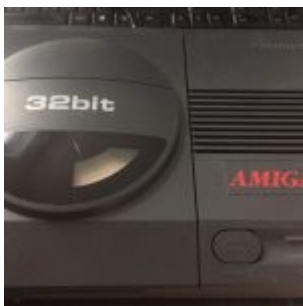
Riss im Sichtfenster des CD32
