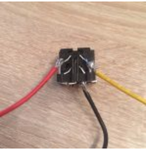
Amiga Power Netzteil Einlötbuchse von hinten
