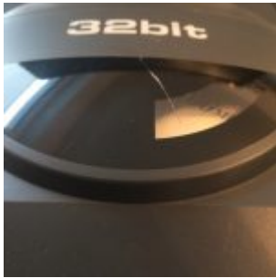
Defektes Amiga CD32 Sichtfenster
