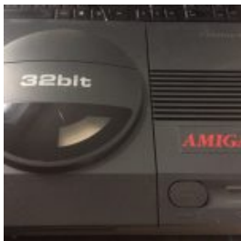
Riss im Sichtfenster des CD32
