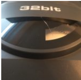
Defektes Amiga CD32 Sichtfenster
