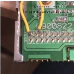
Nun Verbinden wir den PIN 34 mit dem PIN 30 mit Hilfe eines Kabelstückchens.
